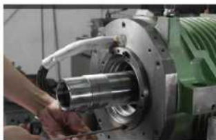
Fig. 3 主軸拆卸過程
