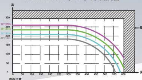
JIH-NC30L : 24吋~30吋 鋸切能力圖
