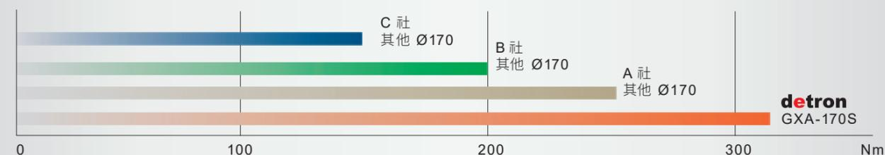
GXA-170S經多次重覆鎖緊力測試後，定位精度依然保持最優數值。每部轉台的煞車力測試與履歷紀錄為標準程序，確保煞車性能。
