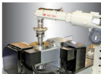
▲ 轉台內部裝置BT50拉刀機構，可夾持BT50刀柄加工，也可搭配機械手臂與工件倉庫，延伸成為FMS彈性製造系統。
