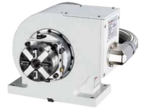
▲ テーブル盤面の代わりに、カスタマイズ治具の取付ける用例。(EROWA製チャック)
