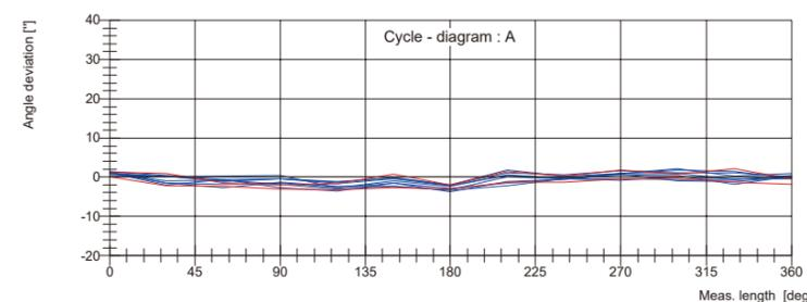
ISO 230-2 に準拠した精度計測法は、正転/逆転の繰り返しで連続5回を実施し、高規格の国際基準です。
