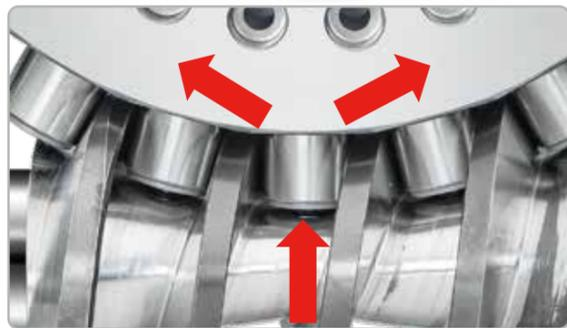
予圧構造によりバックラッシュゼロ、しかも作動中にカムフォロアとカムシャフトの接触は常に4本以上保ち、高剛性実現。
