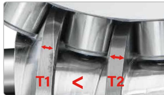
デュアルリードカムシャフトメカニズム( $T1 < T2$ )により、カムフォロアとカムシャフト間の噛合い性能が確保され、振動が大幅に抑えられ、加工時の表面処理精度が向上。
