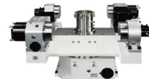
▲ 経済的かつ時間を節約する方法により、カスタマイズ機構の開発時間を短縮します。当社の標準仕様の円テーブルは、僅かな変更で簡易な自動化設備になることができ、例えば、図中のAPC自動パレット交換機構SVW500は標準仕様CX500の進化版で、2セットの4軸GXA-170S円テーブルとSR-170Pテールスピンドルが搭載されています。
