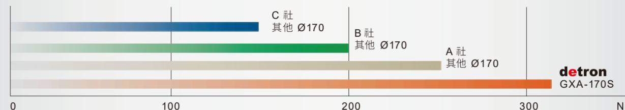
GXA-170Sは複数回の300Nm超のクランプ力で試験した結果、割出精度は依然として最適な値を維持しています。当社の円テーブルは、ブレーキ性能を確保するために、制動力試験及び履歴記録が全て標準手順により実施されます。
