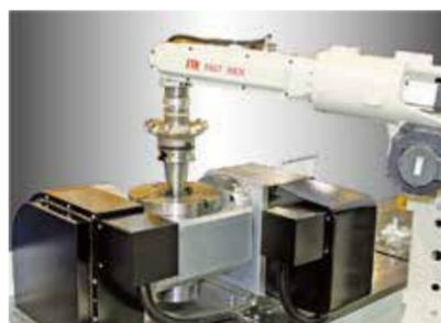
▲ 市販のBT40/50ツールホルダーをワークツールとして使用し、ロボットアームやワークの倉庫を組み合わせることで、FMCフレキシブル生産システムを構成します。
