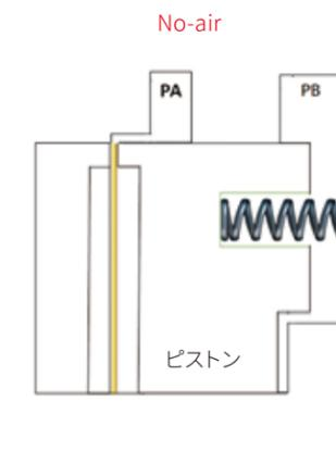
テーブルを落下させないため、空圧がなくなった時スプリングが伸び、40Nmのクランプ力が発生する。
