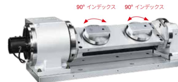
◀ 90°インデックス機構との組み合わせで、定角度の五面加工ができます。インデックス機構は使用ニーズに応じて、マルチステーションを設けることができます。
