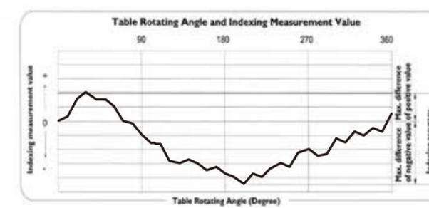
ISO 230-2に準拠した精度計測方法は、正転/逆転の繰り返しで連続5回測定を実施し、高規格の国際基準に準拠しています。
