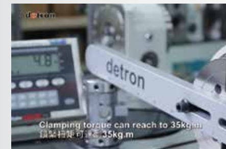
T=F x r T=100kg x 0.36m=36kg.m
